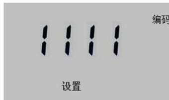
编码方式: 1111 循环投切方式，如三相电容 20kvar，那么所有共补路数对应容量都是 20kvar。默认编码方式为 1111，按→键光标闪烁，按↑键可切换编码方式为 8888，按↓键确认。
