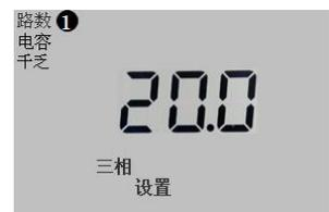
设置每一路的电容容量：按→键光标闪烁，再次操作光标右移一位；按↑键数字加 1，当数字增加到 9 后再次操作便会返回到 0；容量设置好后，按↓键确认并进入到下一路的容量设置。
