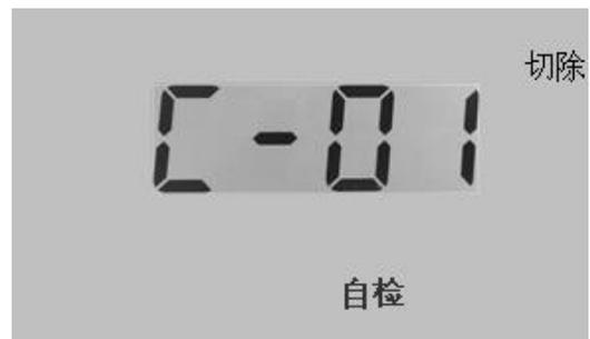
在自检模式下控制器自动地逐路循环投入和切除，每隔 5s 一次，用于电容柜出厂试验。投切开关后面不得接入电容器，电容柜实际投入后也不可进入自检状态，否则将造成电容器损坏。
